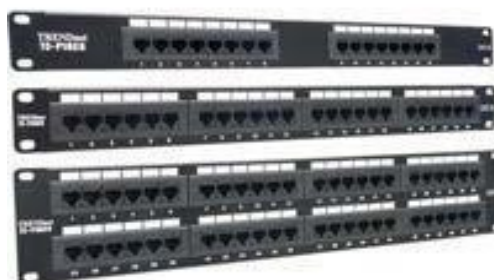
Figura 56: Exemplos de patch panels CAT-6 com conectores RJ-45 tipo fêmea, para cabeamento horizontal em racks padrão 19", conforme especificações deste memorial técnico
